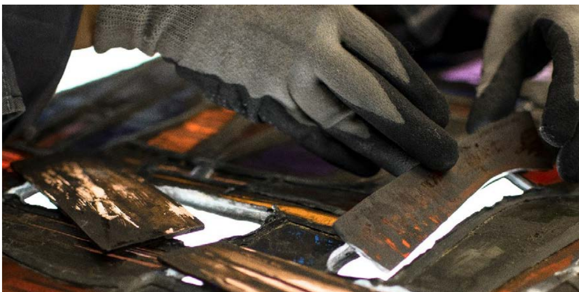
wll c3 Einarbeiten von Duplikaten in das Bleinetz in der Werkstätte
