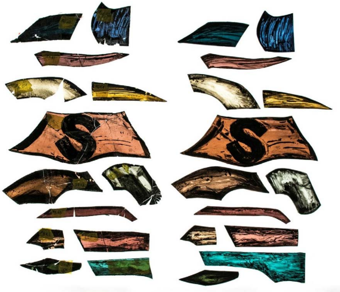
Duplikate diverser Fenster in der Werkstatt. Alle Duplikate wurden mit dem Verweis „Studio Medicus 2021“ versehen.
